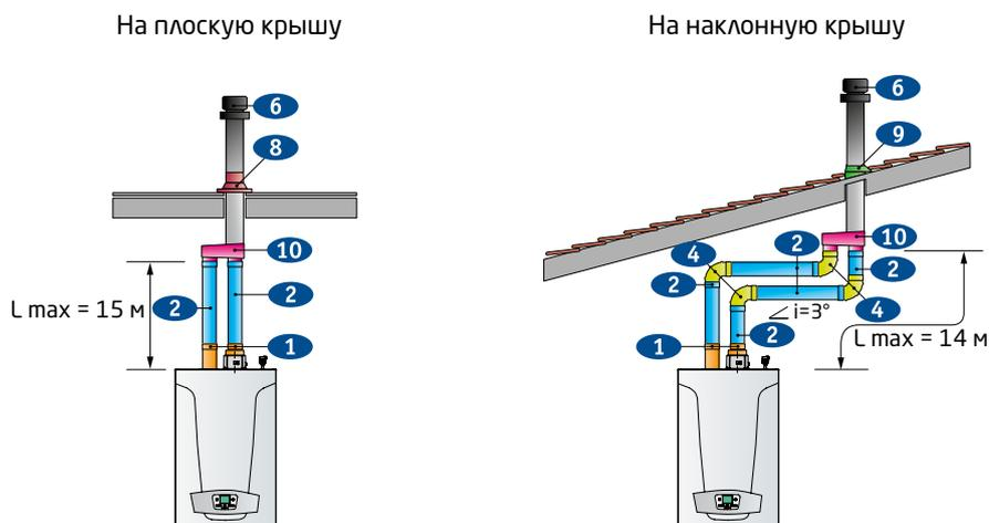
**Примечание:** На схемах указан уклон и его направление.  $i=3^\circ$  означает уклон в  $3^\circ$ , который предусмотрен конструкцией дымовых труб для конденсационных котлов.
