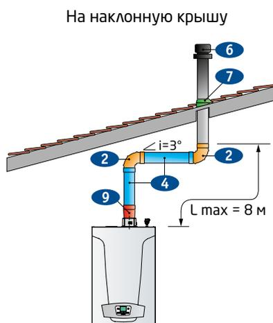
**Примечание:** На схемах указан уклон и его направление.  $i=3^\circ$  означает уклон в 3°, который предусмотрен конструкцией дымовых труб для конденсационных котлов.
