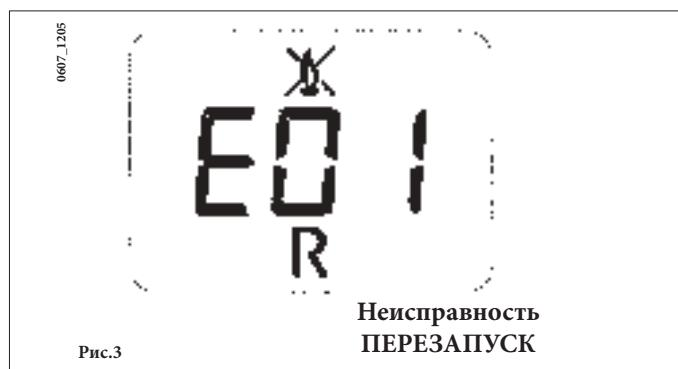
В случае неисправности на дисплее появится ее код (например, E 01):
