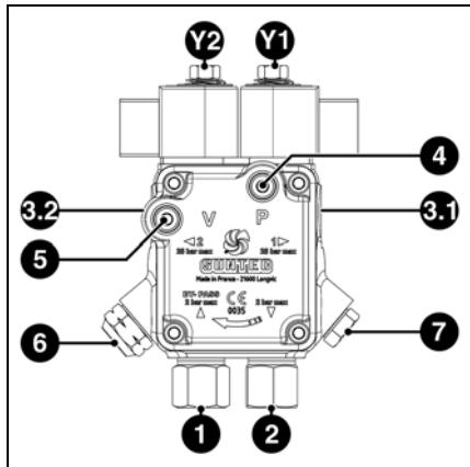
Насос шестрнчатого типа, самовсасывающий. Он должен присоединяться к двум трубопроводам через фильтр для удаления газов. Для соединения между топливной цистерной и фильтром для удаления газов предпочтителен однотрубный вариант. В насосе имеется входной фильтр и регулятор давления топлива. Перед пуском в работу установите манометр для измерения давления 4 и разрежения 5.
