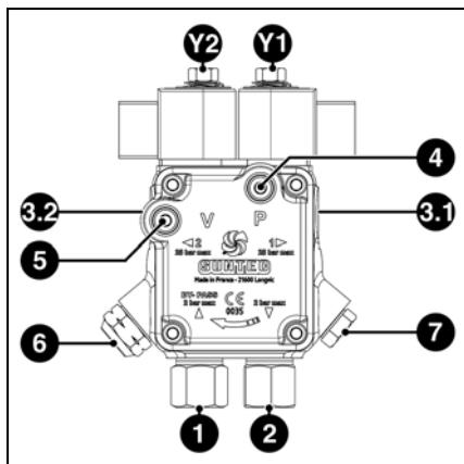
La bomba es de engranajes. La conexión de la misma debe hacerse con doble tubo a través de un filtro de desgasificación. Para la conexión entre la cisterna de gasóleo y el filtro de desgasificación, es preferible optar por la opción monotubo. La bomba incorpora un filtro de aspiración y un regulador de presión de gasóleo. Antes de la puesta en servicio, se debe instalar un manómetro para medir la presión (4) y el vacío (5).
