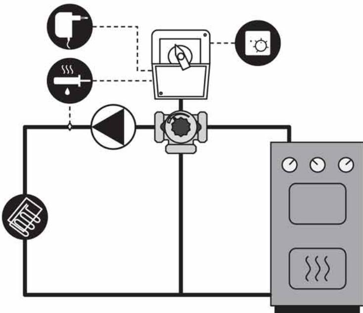
Vexve AM CTR - для систем, работающих на твердом топливе
